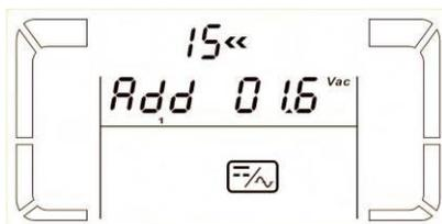
14.- En caso de que los voltajes de salida sean correctos, ya pueden cerrarse las protecciones de salida externas de cada uno de los UPS de forma progresiva: primero UPS N°1, luego N° 2, etc. En este momento todas las salidas AC de los UPS están eléctricamente conectadas en paralelo.
